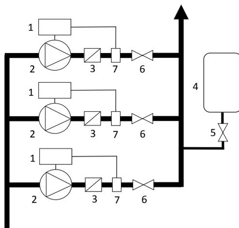
1: Inverter; 2: Pompa; 3: Valvola di non ritorno; 4: Vaso d' espansione; 5: Saracinesca; 6: Saracinesca; 7: Sensore di pressione
