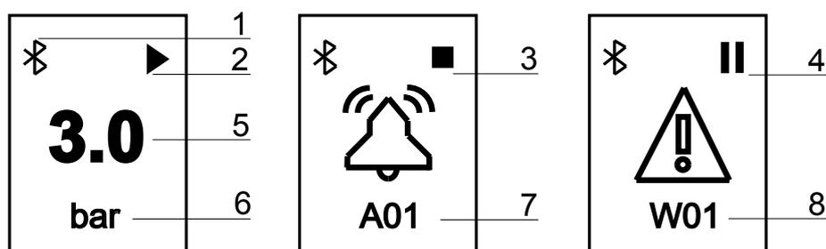
1: Bluetooth attivo. Lampeggiante durante la comunicazione; 2: Motore in funzionamento; 3: Motore arrestato; 4: Stand-by; 5: Valore letto; 6: Unità di misura; 7: Allarme; 8: Avviso
