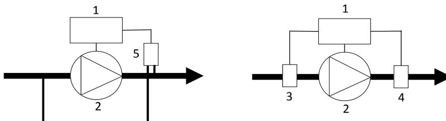
1: Inverter; 2: Pompa; 3: Sensore di pressione; 4: Sensore di pressione; 5: Sensore di pressione differenziale
