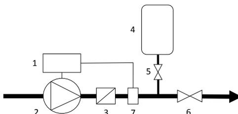
1: Inverter; 2: Pompa; 3: Valvola di non ritorno; 4: Vaso d' espansione; 5: Saracinesca; 6: Saracinesca, 7: Sensore di pressione
