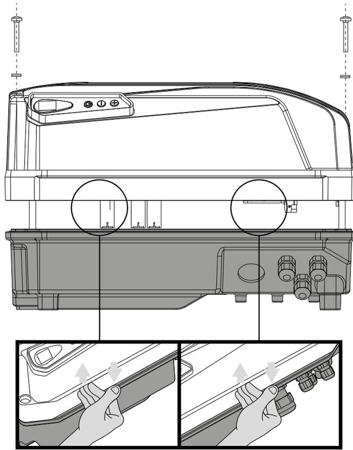
Nei dispositivi taglia 2, il collegamento di terra tra la base e la potenza avviene mediante quattro perni metallici sulla parte di potenza che si innestano in quattro appositi fori sulla base dotati di contatti a molla. Allo stesso tempo tali perni metallici servono da guida per un corretto accoppiamento tra la base e il dissipatore.
